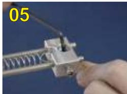
Fuhr den Draht ins Loch im Würfel I ein und befestigen ihn mit Schraube.
