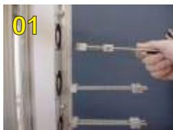
Auf der Antriebsleiste sollst du den Spanner des Drahtes montieren, der die Spannungsfeder hat.
