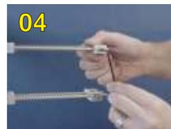
Die Spannungsfeder I soll gespannt werden – mit Hilfe des Inbusschlüssels sollst du sie in die gewählte Lage blockieren.
