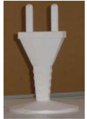
Vor dem Beginn der Gestaltung muss man entschieden, mit wie vielen Rissen wir den Schnitt machen werden. Riss ist eine Form des Block, die aus verschiedenen Winkeln gesehen wird. Je mehr Risse, desto genauer wird der Block ausgeschnitten. Während des Ausschneidens macht der Drehtisch Wende um 180 Grad. Dieser Winkel wird in Teile geteilt. Die Zahl der Teile ist mit der Zahl der Risse gleich.
